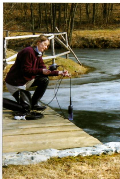
*S sondom Hydrolab Quanta, kupljeno v projektu LIFE, smo zbrali podatke za preverjanje kakovosti vode na več kot 30 mestih po vodotokih in jezerih na Goričku*
